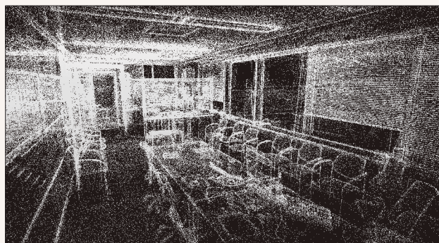
写真2 ActiVRのもととなる点群データ
