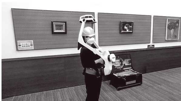
図表1 ウェアラブル型3Dスキャナーを使った撮影
