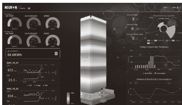
図表 2 Neuron の監視画面、ビルの絵は階ごとの人数をヒートマップで表示している ©Arup
