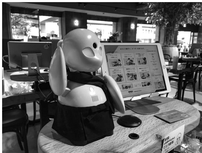
テーブル席には1台ずつ OriHime が設置され、パイロットと会話ができる
