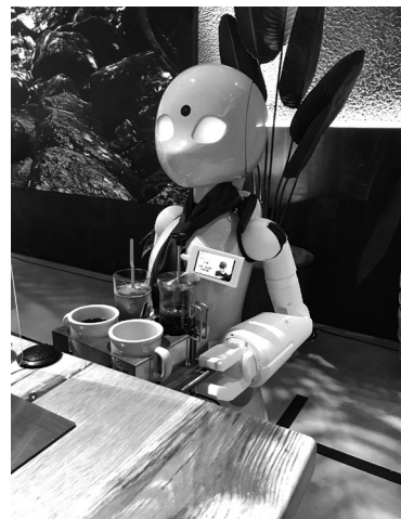
テーブルにドリンクを運ぶ OriHime。パイロットが遠隔で操作をしている
