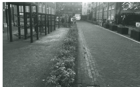
写真2 アムステルダム市公共空間 緑地、レンガタイルの排水溝・道路・歩道、植栽ボックスによる構成
