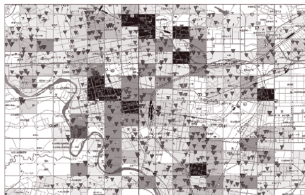
図表 3 仙台市内の陥没分布(黒い部分が陥没の多い地区であり、これらの地区で集中的に調査や改築を行っていく)
